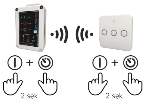
Inläring av manöverpanel
